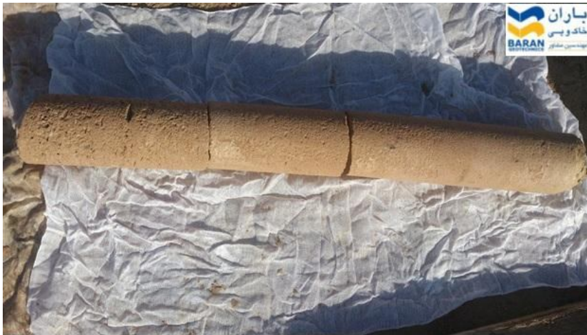
شکل ۲: نمونه دست خورده اخذ شده
