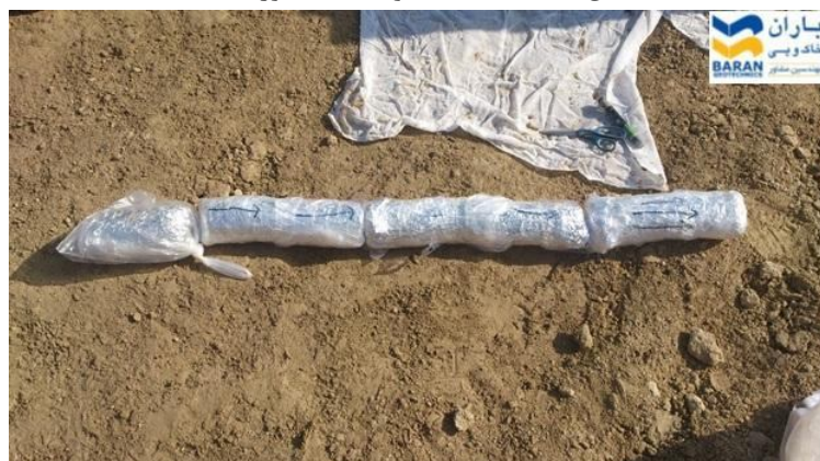
شکل ۶: بسته بندی نمونه دست خورده
