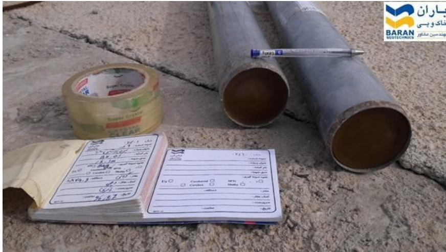
شکل ۱۱: نمونه شلبي موم اندود شده اخذ شده
