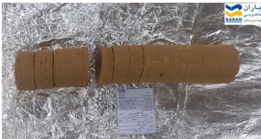
شکل ۳: نمونه دست خورده اخذ شده
