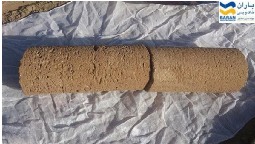
شکل ۱: نمونه دست خورده اخذ شده
