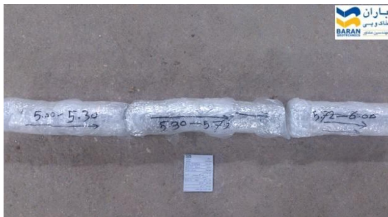
شکل ۴: بسته بندی نمونه دست خورده
